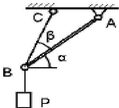
2. Груз весом  $P = 10$  Н подвешен на двух тросах AB и BC, составляющих с горизонтальной прямой углы  $\beta=15^\circ$  и  $\alpha=30^\circ$ . Определить усилия в тросах.
